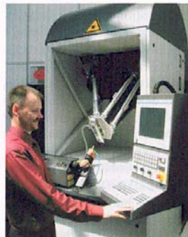
Laserschneidapplikation zum Besäumen von Kunststoffspritzteilen mittels neuartiger Hexapod-Technologie
